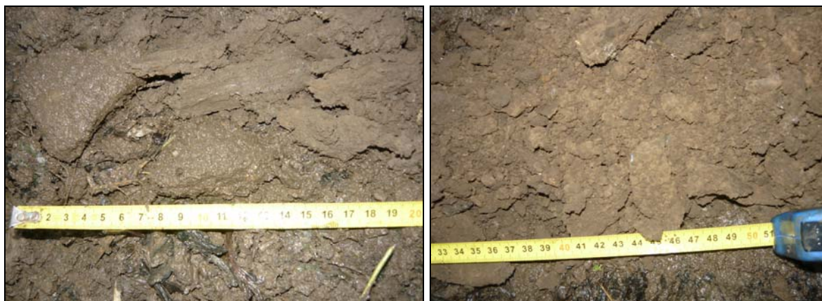
Obrázky 4,5 : Fotodokumentace vrtu V1, ornice a humusový horizont
